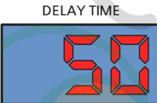
TM ⇒ Solenoid Valve Delay Time Mode(Flicker)
